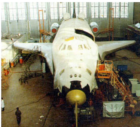
Аналог ОК "Буран", дооснащенный четырьмя двигателями, осуществивший ряд полетов с подмосковного аэродрома в г.Жуковском, для отработки пилотирования при посадке после орбитального полета
